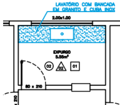
Figura 11. Trecho do projeto básico com indicação de bancada em granito na área de expurgo
